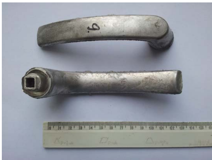
Rys. 1. Fotografie powierzchni odlewów klamki
