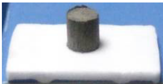
Rys. 2. Próbką popiołu na ceramicznej podstawie
