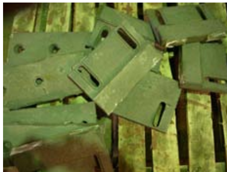
Rys. 18. Odlewy płyt przecieraka, staliwo G17CrMoV-5,1; masa - ok. 4 kg
