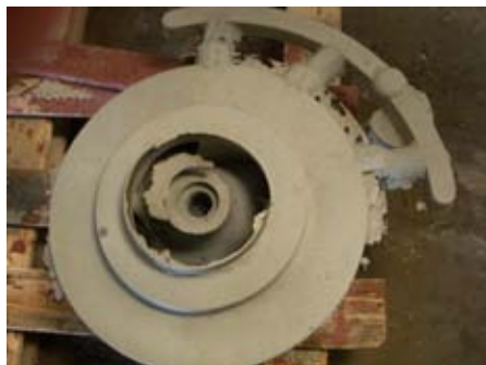
Rys. 17. Odlew wirnika, stal LH18S2, masa - ok. 20 kg
