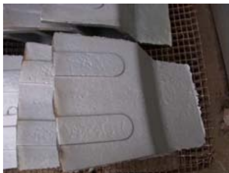
Rys. 19. Segment pierścienia, staliwo LH27N5GW, masa odlewu - ok. 75 kg
