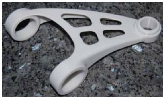
Rys. 16. Model ażurowego wahacza wykonany w technice FDM
