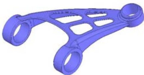
Rys. 10. Żeliwny, cienkościenny model ażurowy o zmniejszonej masie
