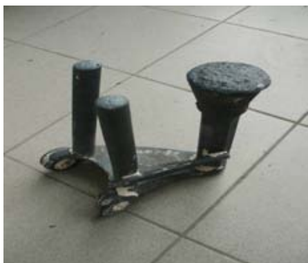
Rys. 7. Odlewy wahacza po rozbiciu form ceramicznych wykonane w technologii I i II
