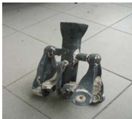
Rys. 7. Odlewy wahacza po rozbiciu form ceramicznych wykonane w technologii I i II
