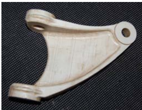
Rys. 2. Model wahacza wykonany z wykorzystaniem techniki LOM
