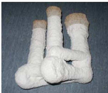
Rys. 6. Forma ceramiczna przygotowana dla technologii I
