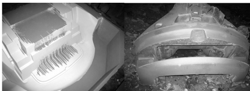
Fot. 5. Wnęką formy wykonana z masy ze spoiwem Rudal A oraz odlew balastu
