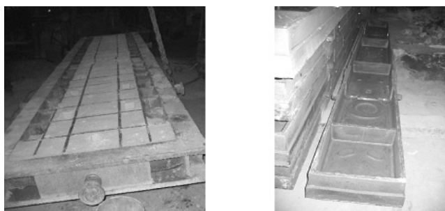
Fot. 4. Forma (górna skrzynka formy) i gotowe odlewy ramy drzwiowej dla koksowni z żeliwa z dodatkiem Cr i Ni
