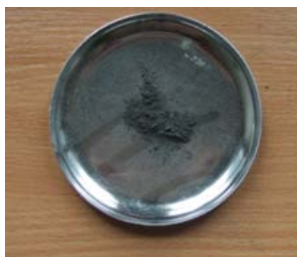
Rys. 10. 800 g proszku Al + 160 g K_2TiF_6 + 75 g KBF_4
