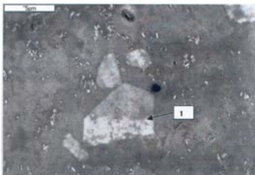
Rys. 3. Mikrostruktura zaprawy AlTi5B1
