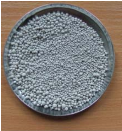
Rys. 25. 475 g proszku Al + 25 g SiC (95% wag./5% wag.)
