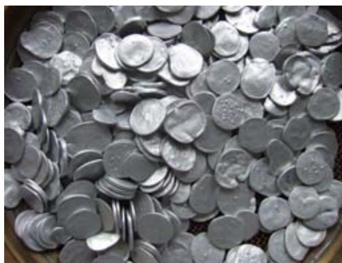
Rys. 7. Rozkute pręty AlTi5B1
