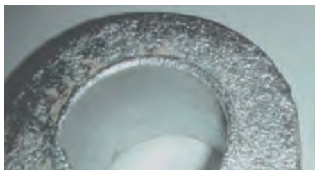
Rys. 17. Powierzchnia odlewu próbnego ze stopu \text{AlZn6Mg2Cu1,5Cr} odtworzona przez rdzeń wykonany z masy rdzeniowej, zawierającej popiół lotny jako osnowę ziarnową oraz spoiwo w postaci uwodnionego krzemianu sodu utwardzone termicznie
