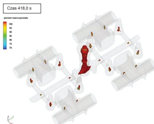
Rys. 4. Prognozowana porowatość w odlewie Fig. 4. Forecast of porosity in the body cast
