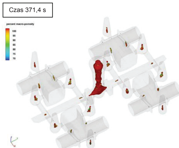
Rys. 9. Prognozowana porowatość w odlewie korpusu Fig. 9. Forecast of porosity in the body cast
