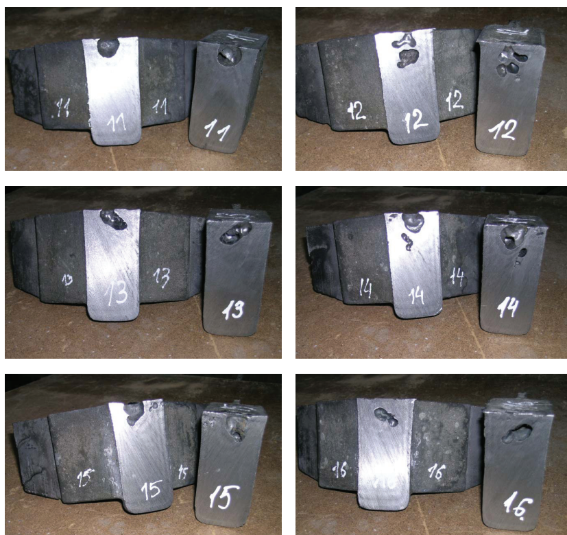
Rys. 5. Wady typu skurczowo-gazowego we wlewkach rozetowych z wytopów 11 do 16
