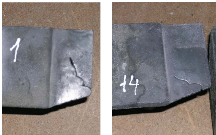
Rys. 3. Wady nieciągłości materiału w ściankach odlewów rozetowych o grubości 3 mm z wytopów nr 1 i 14 Fig. 3. Defects of material discontinuity in the walls of rosette casts 3 mm thick from casts no 1 and 14
