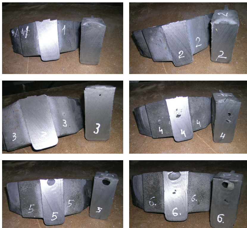
Rys. 4. Wady typu skurczowo-gazowego występujące w najgrubszych ściankach wlewków rozetowych pochodzących z wytopów 1 do 6
