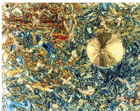
Rys. 19. Mikrostruktura próbki nr 12. Martenzyt, bainit górny, austenit, węgliki, grafit kulkowy. Pow. 500x Fig. 19. Microstructure of sample no. 12. Martensite, upper bainite, austenite, carbides, vermicular graphite. Magnification 500x
