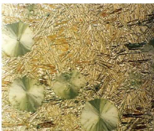
Rys. 25. Żeliwo ADI w gatunku 1200-2. Ferryt płytkowy, austenit, grafit kulkowy. Pow. 1000x
