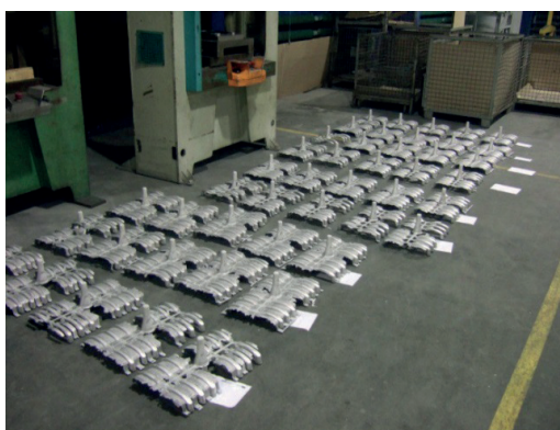
Rys. 14. Odlewy przeznaczone do badań mechanicznych i strukturalnych Fig. 14. Castings for mechanical and structural testing
