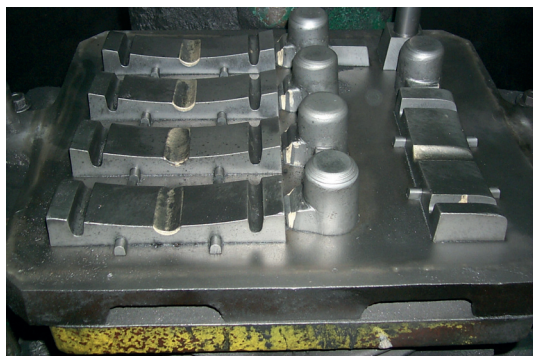
Rys. 1. Płyta modelowa górna i dolna wstawki hamulcowej DO-250B. Druga wersja z nadlewami czołowymi, belka wlewna przechodzi przez nadlewy
