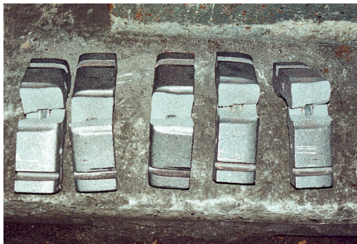
Rys. 4. Wykonane z zastosowaniem oprzyrządowania testowego wersji II odlewy wstawek DO-250B. Po próbie kafarowej przełomy odlewów były bez wad
