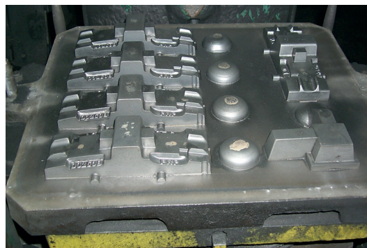
Rys. 1. Płyta modelowa górna i dolna wstawki hamulcowej DO-250B. Druga wersja z nadlewami czołowymi, belka wlewna przechodzi przez nadlewy
