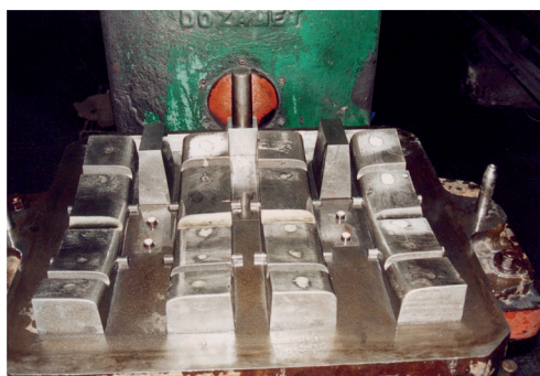
Rys. 3. Płyta modelowa górna i dolna wstawki hamulcowej DO-380B. Czwarta wersja z nadlewami bocznymi
