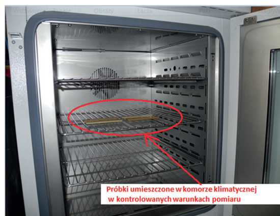
Rys. 2. Próbki umieszczone w komorze klimatycznej Fig. 2. The samples placed in the climate chamber
