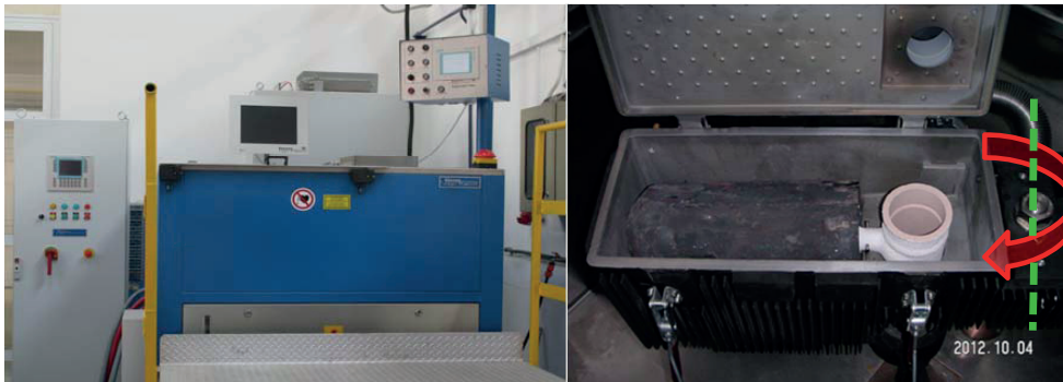
Rys. 2. Indukcyjny odśrodkowy piec próżniowy SuperCast
