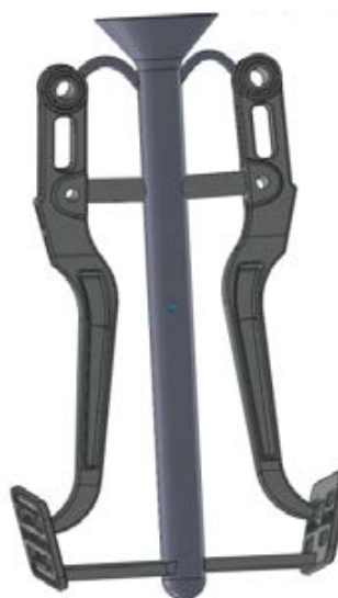
Rys. 10. Model technologii odlewania dźwigni pedału hamulca: a) kształt pierwotny, b) model po kształtowaniu topologii konstrukcji
