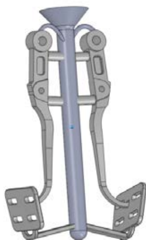
Rys. 10. Model technologii odlewania dźwigni pedału hamulca: a) kształt pierwotny, b) model po kształtowaniu topologii konstrukcji
