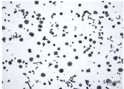
Rys. 9. Postać grafitu w żeliwie z wytopu przemysłowego
