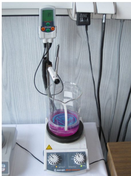
Rys. 10. Wyfukiwanie materiału podporowego z wydrukowanego modelu medalu przy pomocy mieszadła magnetycznego
