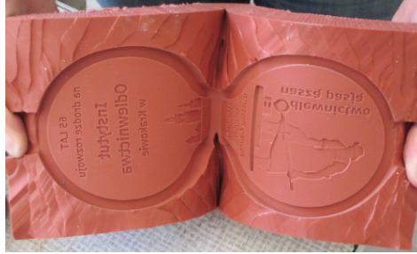
Rys. 15. Widok dwóch połówek gotowej matrycy
