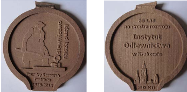
Rys. 21. Awers i rewers medalu okolicznościowego po zabiegu piaskowania
