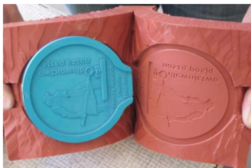
Rys. 14. Usunięcie wzorcowego modelu z gotowej matrycy
