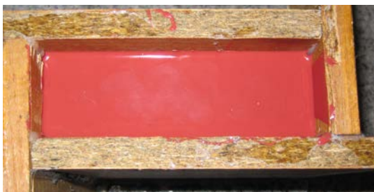
Rys. 13. Widok formy zalanej kauczukiem silikonowym
