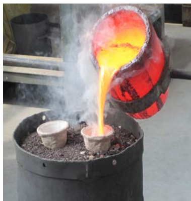
Rys. 18. Zalanie formy ceramicznej ciekłym brązem B555
