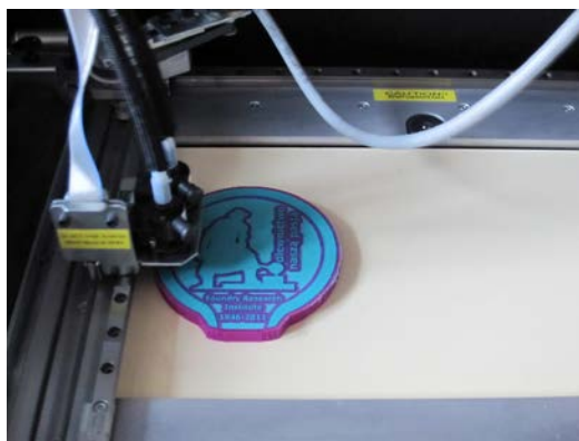
Rys. 8. Drukowanie awersu medalu okolicznościowego na urządzeniu Solidscape T612BT
