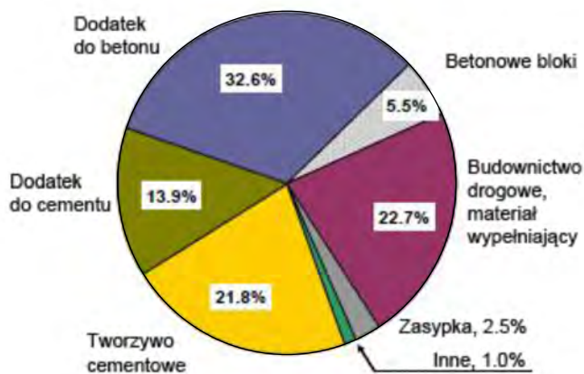
Rys. 10. Diagram przedstawiający kierunki wykorzystania popiołów lotnych w przemyśle budowlanym i podziemnych technologiach górniczych w Unii Europejskiej (15 krajów) w 2008 r. [19]
