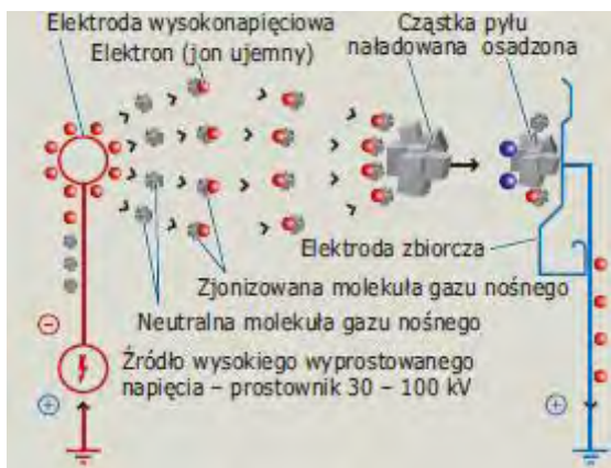
Rys. 7. Zasada działania elektrofiltru [17]
