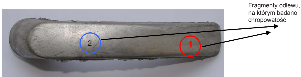
Rys. 4. Fragment powierzchni odlewu przeznaczony do badań chropowatości powierzchni: 1 – powierzchnia formy zniszczona, 2 – powierzchnia gładka
