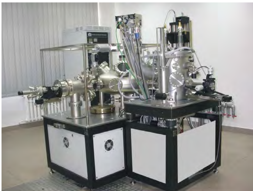
Rys. 1. Uniwersalny zestaw aparaturowy do kompleksowych badań właściwości ciekłych metali i stopów w wysokiej temperaturze opracowany w Instytucie Odlewnictwa [13]
