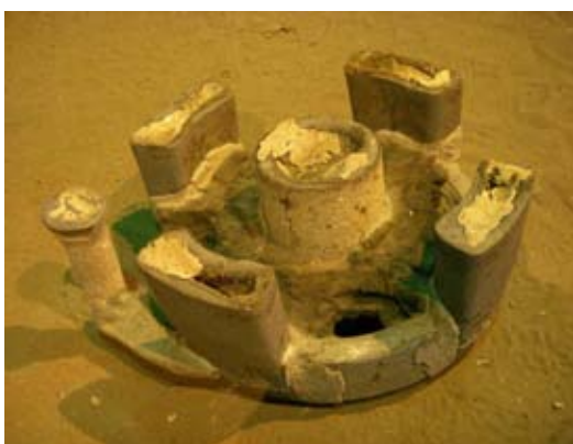
Rys. 21. Przykładowy odlew po wybicciu z formy i przed obcięciem układu wlewowego i zasilaczy
