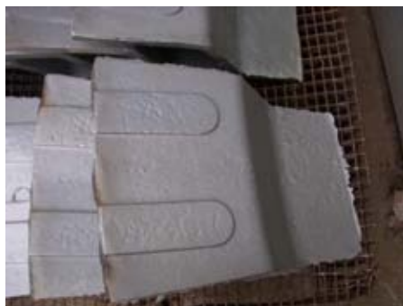
Rys. 19. Segment pierścienia, staliwo LH27N5GW, masa odlewu - ok. 75 kg
