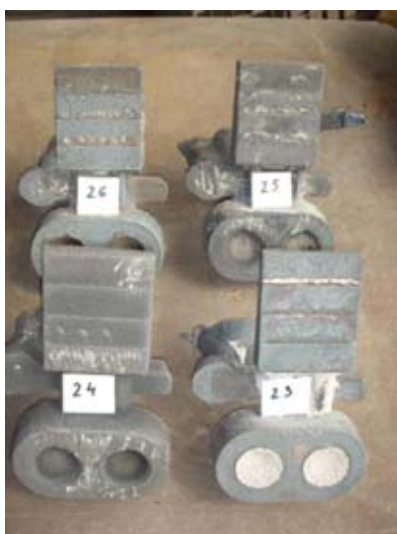
Rys. 3. Wykonane przykładowe odlewy testowe po wybiciu z formy
