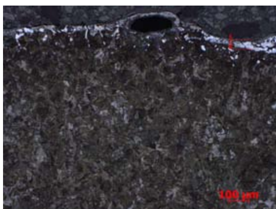
Rys. 16. Staliwo forma suszona. Mikrostruktura próbki nr 16, pow. 100x, zgląd trawiony Fig. 16. Cast steel, dry sand mould. Microstructure of specimen no 16, 100x, etched section.
