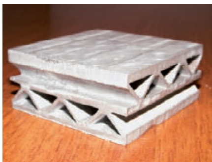
Rys. 10. Odlew konstrukcji komórkowej ze stopu AK12 wykonany metodą wytapianego wosku
