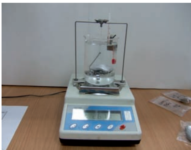
Rys. 5. Ogólny widok stanowiska do pomiaru gęstości próbek
