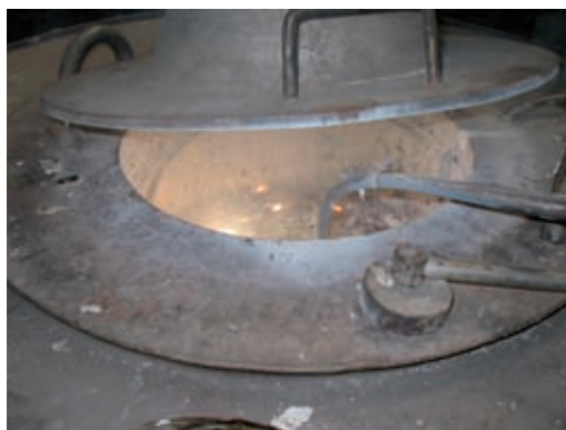
Rys. 4. Rafinacja gazowa stopów magnezu za pomocą lancy
