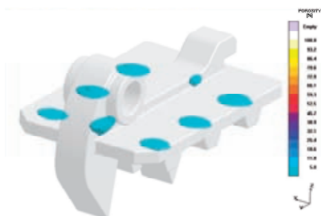
Rys. 4. Porowatość w odlewie w wyjściowej technologii Fig. 4. Porosity in casting made by the previously used technology
