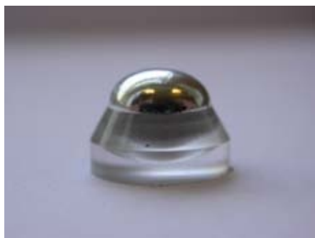
Rys. 4. Fotografia kropli cyny w tyglu szafirowym po pierwszym badaniu napięcia powierzchniowego
