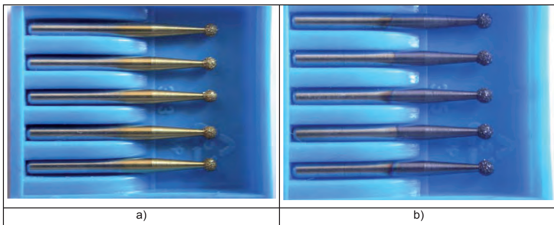
Rys. 1. Wiertła stomatologiczne kulkowe pokryte: a) TiN (żółte) i b) TiAlN (niebieskoszare)
