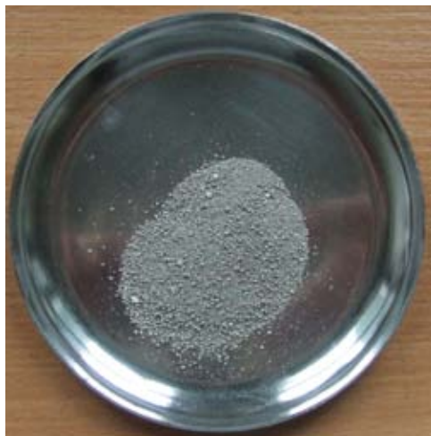
Rys. 27. 95 g proszku Al + 5 g C_{graf} Fig. 27. 95 g powdered Al + 5 g C_{graf}
