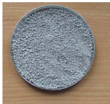
Rys. 9. 475 g proszku Al + 25 g gąbki tytanowej (95% wag./5% wag.)
