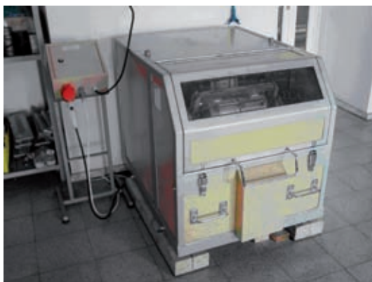
Rys. 1. Młyn wysokoenergetyczny do mielenia i mechanicznego stopowania materiałów proszkowych
