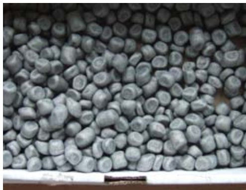
Rys. 6. Pocięte pręty AlTi5B1
