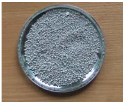
Rys. 8. 425 g proszku Al + 75 g gąbki tytanowej (85% wag./15% wag.)
