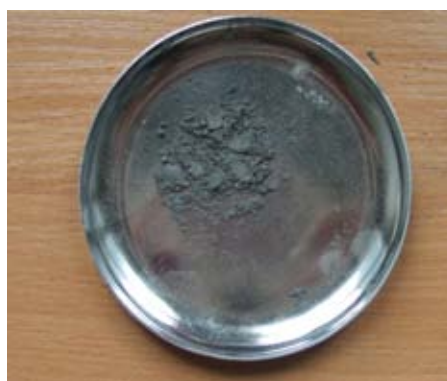
Rys. 11. 380 g proszku Al + 80 g K_2TiF_6 + 40 g KBF_4
