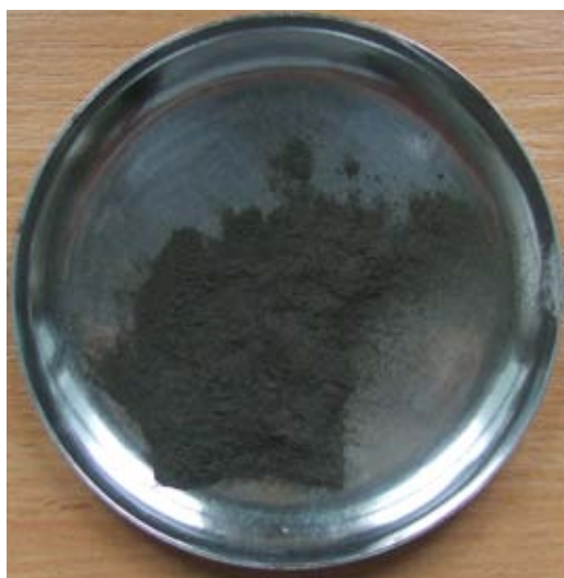
Rys. 30. 10 g proszku Al + 1 g C_{aktyw} Fig. 30. 10 g powdered Al + 1 g C_{aktyw}
