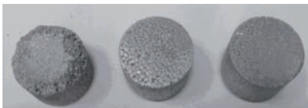
Rys. 35. Wypraski powstałe ze sprasowania mieszanki proszku Al z gąbką tytanową (95% wag./5% wag.)
