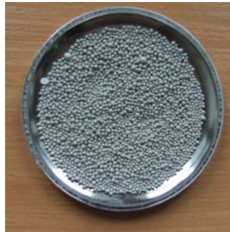
Rys. 26. 425 g proszku Al + 75 g SiC (85% wag./15% wag.)
