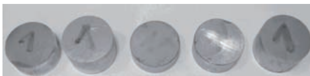
Rys. 34. Próbkki cylindryczne (prasowane na zimno) z proszku Al + 40 g K_2TiF_6 + 20 g KBF_4
