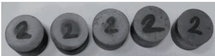
Rys. 33. Próbkki cylindryczne (prasowane na zimno) z proszku Al + 160 g K_2TiF_6 + 75 g KBF_4
