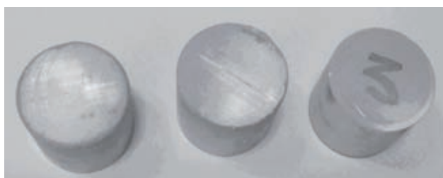
Rys. 32. Próbki cylindryczne (prasowane na zimno) z proszku Al + 20 g K_2TiF_6 + 10 g KBF_4
