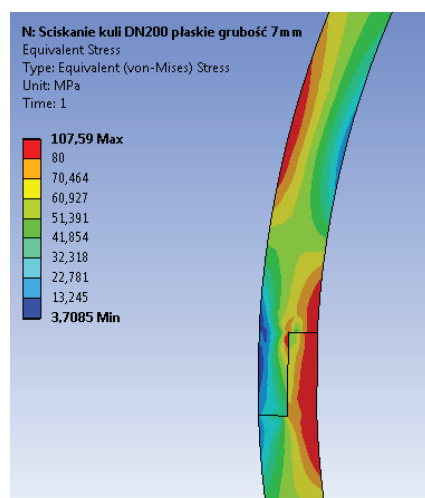
Rys. 20. Rozkład maksymalnych wartości naprężeń uogólnionych dla czaszy żeliwnej o grubości ścianki 7 mm Fig. 20. Distribution of the maximum generalized stress values for the cast iron dome with 7 mm of wall thickness
