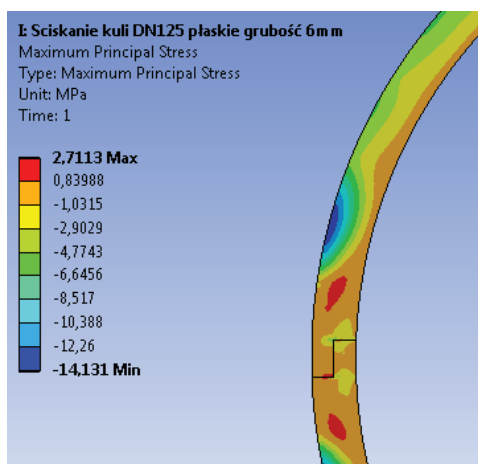
Rys. 12. Rozkład pól maksymalnych naprężeń głównych dla czaszy żeliwnej o grubości ścianki 6 mm Fig. 12. Distribution of the fields of maximum primary stresses for the cast iron dome with 6 mm of wall thickness
