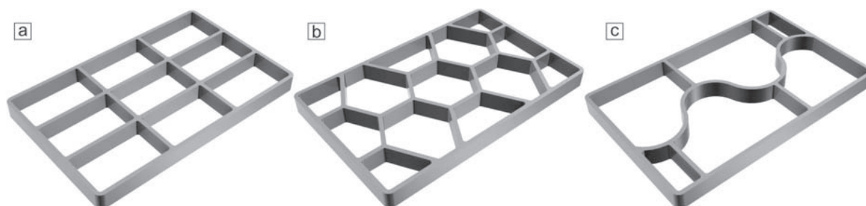
Rys. 2. Typowe połączenia ścianek odlewu ażurowego wg [7]: a) „krzyżowe” – połączenie typu X, b) „plaster miodu” – Y, c) „faliste” – T
