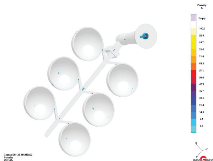
Rys. 4. Rozkład porowatości w odlewach czaszy DN125
