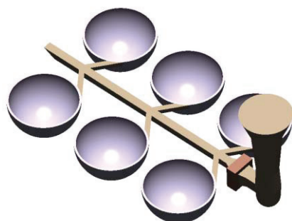
Rys. 1. Rysunek odlewów czaszy DN125 z układem wlewowym
