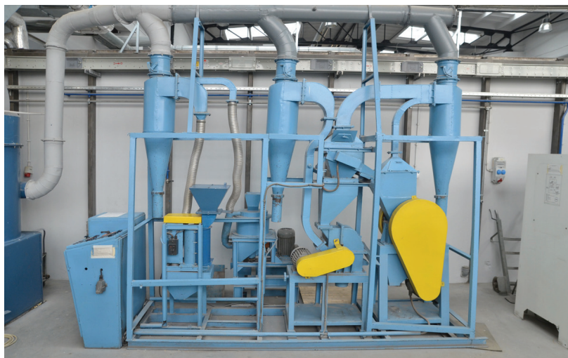
Rys. 1. Modelowe stanowisko regeneracji mechanicznej piasków z mas samoutwardzalnych zainstalowane w Instytucie (fot. J. Witkowski)
