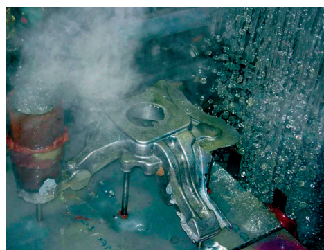
Rys. 2. Realizacja procesu odlewania ablacyjnego [4] Fig. 2. The execution of the process of ablation casting [4]
