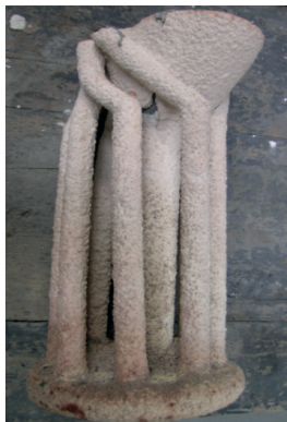
Rys. 1. Forma oraz odlew wykorzystywany do oznaczania lejności Fig. 1. Mould and cast used to determine fluidity
