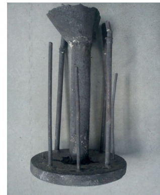
Rys. 1. Forma oraz odlew wykorzystywany do oznaczania lejności Fig. 1. Mould and cast used to determine fluidity
