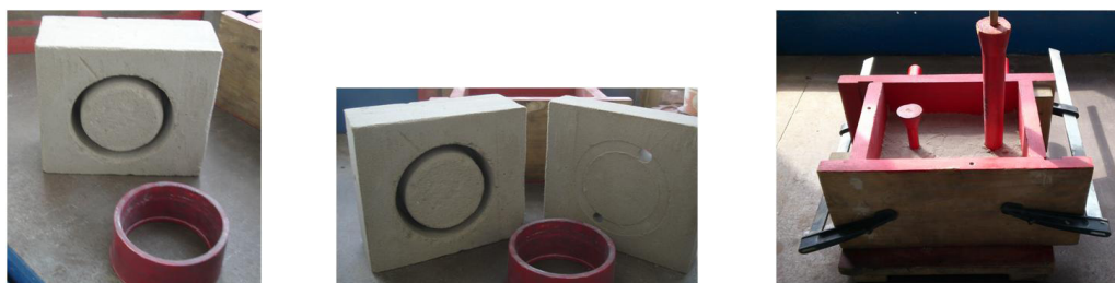
Rys. 6. Wykonywanie form z zastosowaniem modelu w kształcie pierścienia
