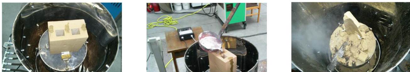
Rys. 12. Przebieg procesu ablacyjnego wybijania form schodkowych w ustawieniu pionowym
