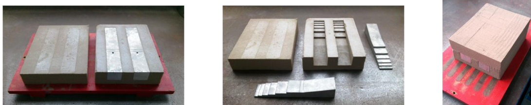
Rys. 11. Formy do wykonywania odlewów schodkowych – ustawienie pionowe Fig. 11. Moulds for stepped castings placed vertically
