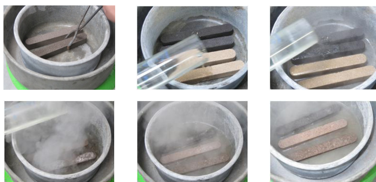
Rys. 4. Destrukcja nagrzaných próbek pod wpływem czynnika chłodzącego – 10% roztworu PhE8 Fig. 4. Hot test samples undergoing destruction under the impact of a cooling medium – 10% solution of PhE8
