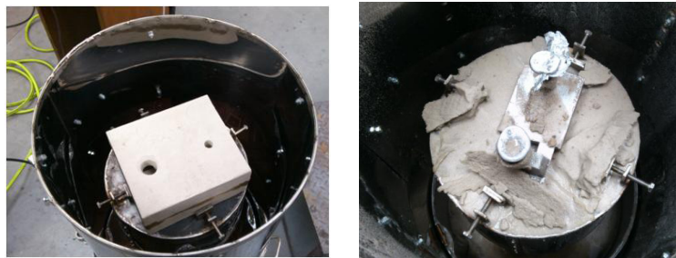
Rys. 9. Ablacyjne wybijanie form schodkowych w ustawieniu poziomym Fig. 9. Ablation knocking out of stepped moulds placed horizontally
