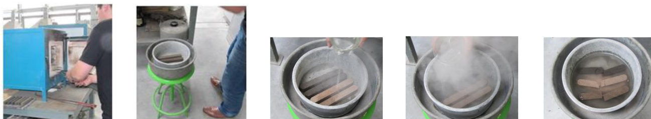
Rys. 3. Destrukcja nagrzaných próbek pod wpływem czynnika chłodzącego – wody Fig. 3. Hot test samples undergoing destruction under the impact of a cooling medium – water
