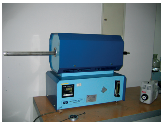
Rys. 1. Piec poziomy z rurą kwarcową
