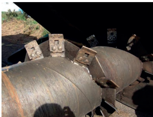
Rys. 2. Lemiesze na wirniku obrotowym przegrucarki Fig. 2. Paddles on the rotating rotor of a turning machine
