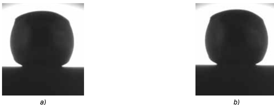
Rys. 3. Obrazy kropli próbki S10 (kompozyt po 10. przetopie i 10. odlewaniu sposobem squeeze casting) na podłożu z tlenku glinu podczas badań w temperaturze 850°C: a) t = 0 s, p = 2,4 \times 10^{-5} mbar, b) t = 15 min, p = 2,6 \times 10^{-5} mbar
