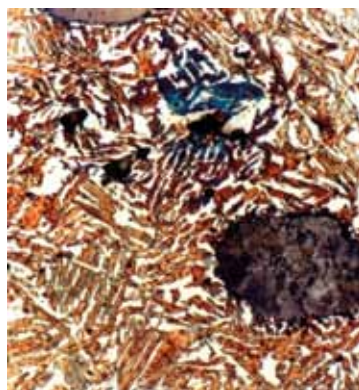
Rys. 13. Mikrostruktura ausferytu we wlewkę o grubości 75 mm
