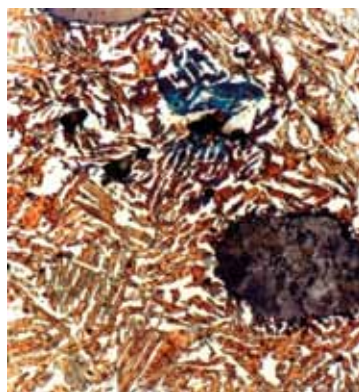
Rys. 13. Mikrostruktura ausferytu we wlewkach o grubości 75 mm
