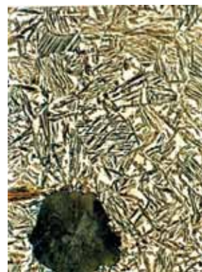
Rys. 12. Mikrostruktura ausferytu we wlewkę o grubości 50 mm
