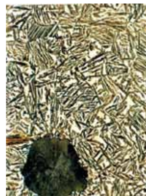
Rys. 12. Mikrostruktura ausferytu we wlewkach o grubości 50 mm
