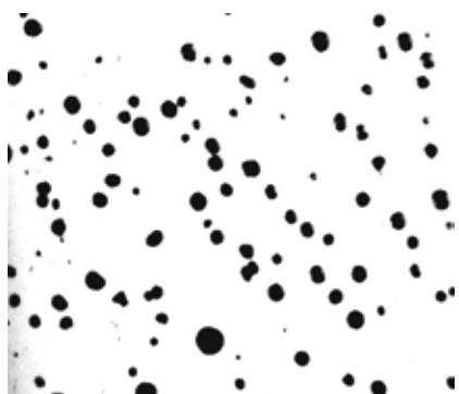
Rys. 8. Grafit w żeliwie wyjściowym przed obróbką cieplną. Wlewek 25 mm. Pow. 100×, nietraw.
