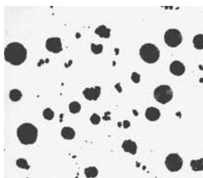
Rys. 9. Grafit w żeliwie wyjściowym przed obróbką cieplną. Wlewek 50 mm. Pow. 100×, nietraw.
