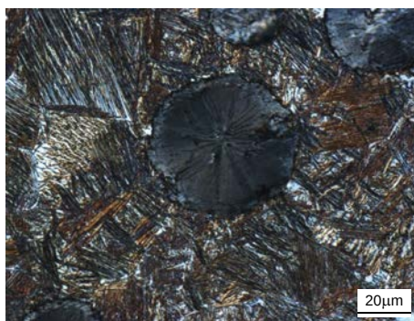
Rys. 4. Przykładowa mikrostruktura żeliwa ADI Fig. 4. Exemplary microstructure of ADI cast iron
