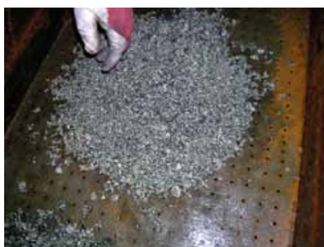
Rys. 9. Granulat staliwa GXCrNiMo18-10-2 uzyskany w wyniku zastosowania ceramicznego filtra odlewniczego Fig. 9. Granulate of cast steel GXCrNiMo18-10-2 obtained as a result of the use of a ceramic casting filter
