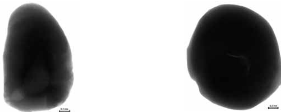
Rys. 11. Zdjęcia rentgenowskie granulek wykonanych z zastosowaniem ceramicznego filtra odlewniczego Fig. 11. X-ray images of the granules made with the use of a ceramic casting filter
