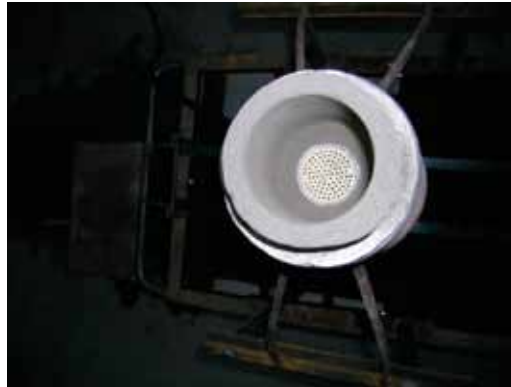
Rys. 7. Ceramiczny filtr odlewniczy zamocowany w tulei, przez który przelewany był stopiony metal Fig. 7. Ceramic casting filter mounted in a bushing, through which the melted metal was poured
