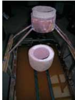
Rys. 3. Zmodyfikowana konstrukcja do granulacji stopów Fig. 3. Modified construction for alloy granulation
