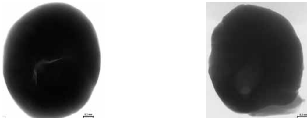
Rys. 10. Zdjęcia rentgenowskie granulki wykonanych z zastosowaniem przepionek Fig. 10. X-ray images of the granules made through the application of neck-down cores
