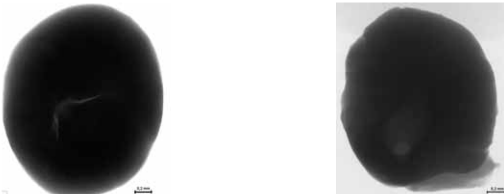
Rys. 10. Zdjęcia rentgenowskie granulki wykonanych z zastosowaniem przeponek Fig. 10. X-ray images of the granules made through the application of neck-down cores
