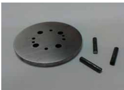
Rys. 9. Próbkę żeliwa CADI oraz przeciwpóbkę ze stali EN-31 Fig. 9. Pin-shaped CADI samples and EN-31 steel counter-sample
