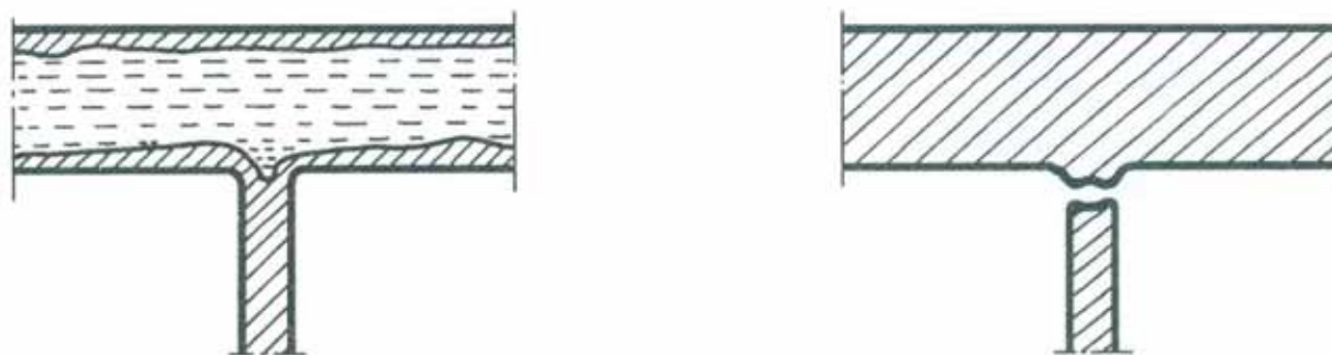
Rys. 1. Schemat powstawania pęknięcia na gorąco [1]
