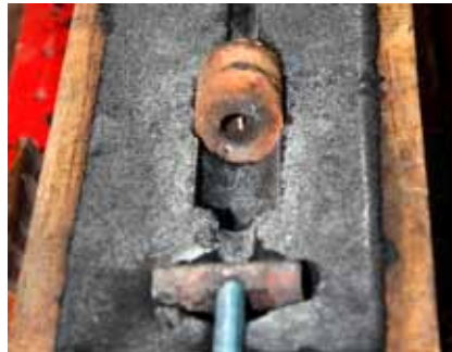
Rys. 12. Tulejka z materiału termoizolacyjnego wraz z widoczną termoparą typu K Fig. 12. Bushing of the thermo-insulating material with the visible K-type thermocouple
