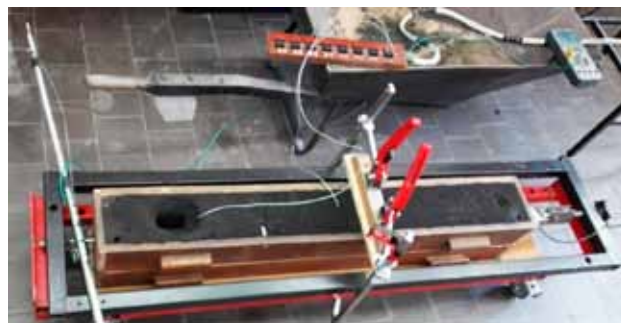
Rys. 13. Stanowisko do badań skłonności do pęknięć na gorąco przygotowane do zalania Fig. 13. Research set-up prepared for pouring
