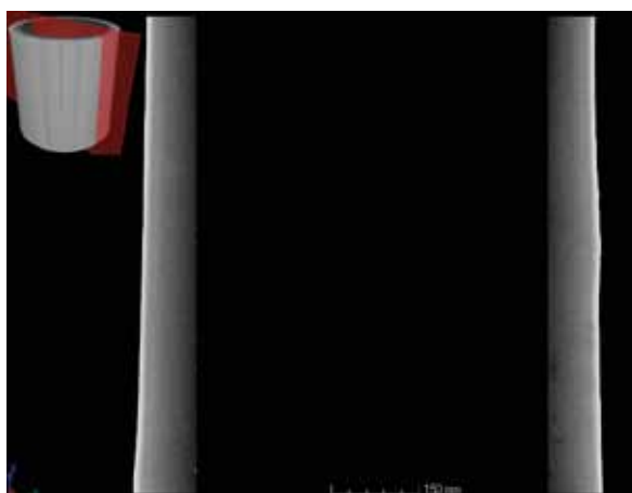
Rys. 5. Wybrany przekrój przedstawiający badaną dyszę zalewaną przez nadlew Fig. 5. Selected section showing the tested nozzle pouring technology from the top through a riser
