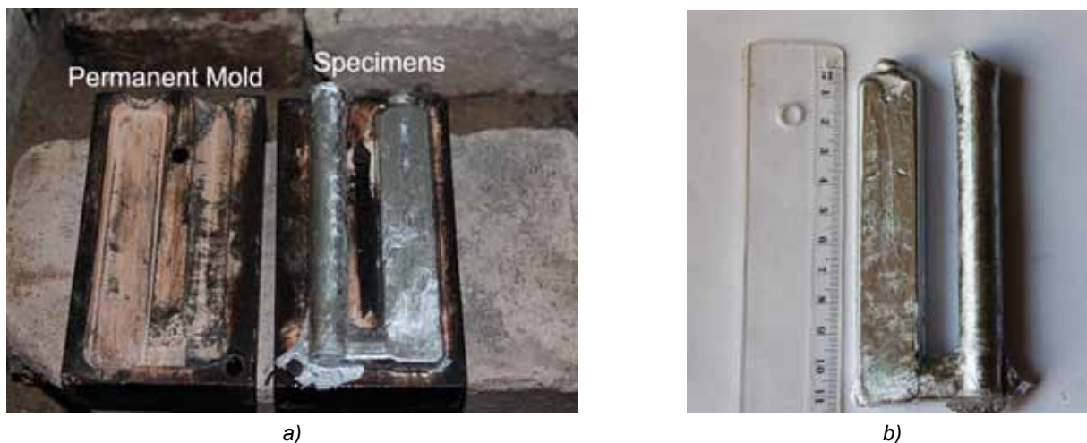
Fig. 4. Mold after casting (a) and specimens obtained from alloys subjected to research program (b) Rys. 4. Forma odlewnicza po odlewaniu (a) oraz próbki otrzymane ze stopów doświadczalnych (b)
