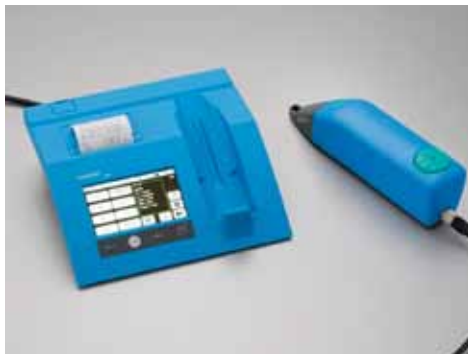
Rys. 3. Urządzenie do pomiaru chropowatości HOMMEL-ETAMIC W20 Fig. 3. HOMMEL-ETAMIC W20 roughness measurement instrument
