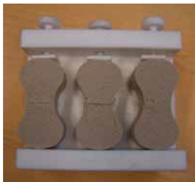
Rys. 1. Przyrząd wykonany z politetrafluoroetyleny (PTFE) ze śrubami pozycjonującymi klejone połówki kształtki ósemkowej typu dog-bone
