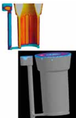
Rys. 12. Brak porowatości w odlewie dyszy DN100 ze stopu H282 zalewanego syfonowo:
