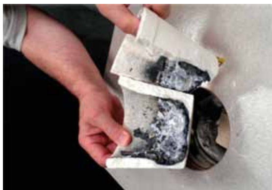
Rys. 13. Efekt reakcji ciekłego stopu IN740 z materiałem ceramicznym tygla laboratoryjnego pieca indukcyjnego Fig. 13. The effect of reaction effect of liquid IN740 alloy with ceramic material of laboratory induction furnace crucible
