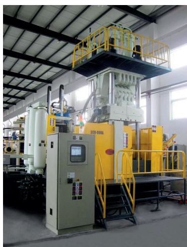
Rys. 11. Hybrydowa maszyna VSC&HPDC o sile zwierania 8000 kN [20]
