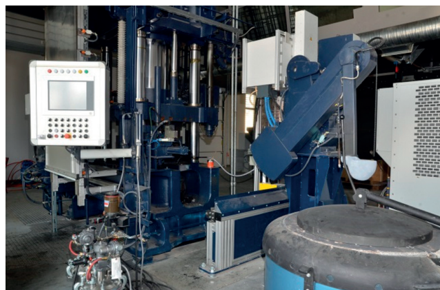
Rys. 13. Stanowisko do prasowania w stanie ciekłym i stało-ciekłym w oparciu o prasę hydrauliczną firmy UBE o siłę zwierania 5000 kN
