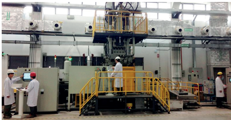
Rys. 9. Pionowa maszyna do prasowania metalu w stanie ciekłym dla stopów magnezu (VSC) [19]
