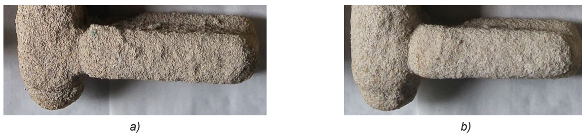
Rys. 2. Przykładowe próbki poddane badaniom CT: a) próbka typu A; b) próbka typu B (wymiary próbek: 200×100×50 mm)
