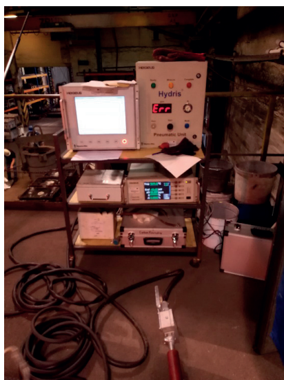
Rys. 1. Zestaw aparatury do pomiaru aktywności tlenu i zawartości wodoru w stali
